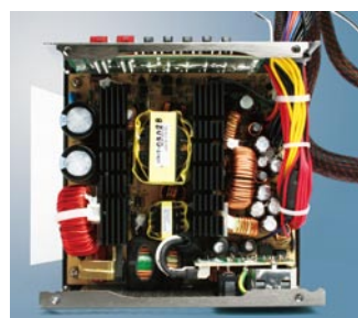
▲使用兩組黑色鋁質散熱片加強散熱，全日系電容也能提高運作時的穩定性
